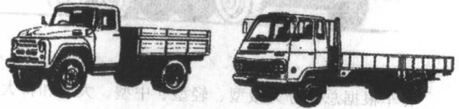
图 0-3 长头载货汽车与平头载货汽车
