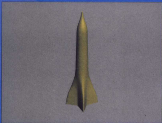
目标 -6 多截面放样生成的导弹模型
