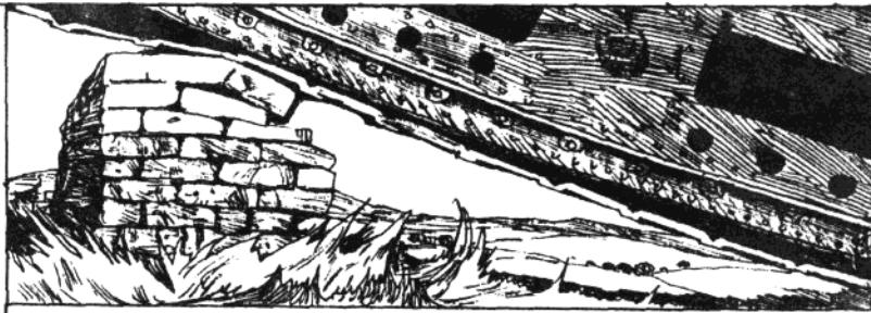
21. 依据配备的武器不同, I 型坦克可分为“雄性”和“雌性”两种, “雄性”装 2 门 57 毫米火炮和 4 挺机枪, “雌性”仅装 5 挺机枪, 乘员 8 人, 最大时速约 6 公里。
