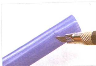
5、圆管以刀笔划出一道切缝 6、向内折处插入圆管切缝。 (须小于嵌入角)。
