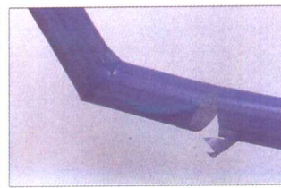
1、依弯曲的方向直剪第二个斜2、参考前项弯曲嵌入法。缺口。
