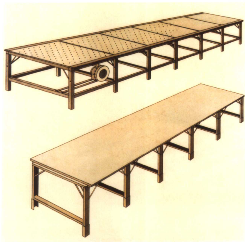
上为气垫裁床,下为普通裁床 彩图 5(图 4-35)铺料台
