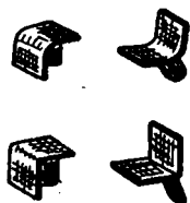
修光凹角和凸角用的工具
