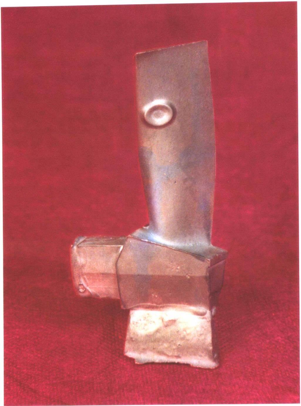
NiAl 合金涡轮叶片毛坯照片
