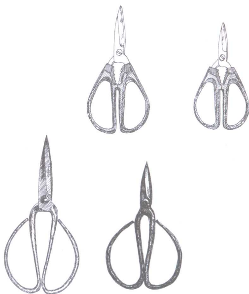
剪刀尖要尖，要长，刀背要薄，铰口要松紧适度
