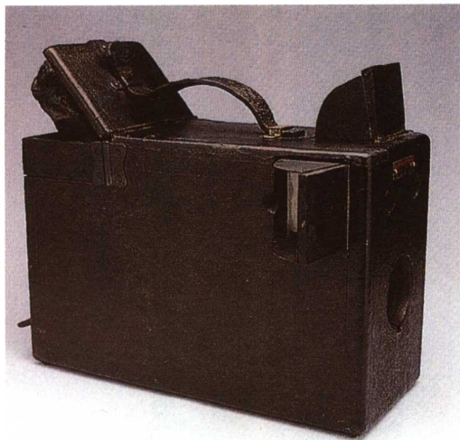
1893年比利时制“ROYAL DETECTIF”相机。具有可拆卸快门及换片板的皮革箱体。相机外观为典型的19世纪后30年间的流行型式，箱式相机的先驱。
