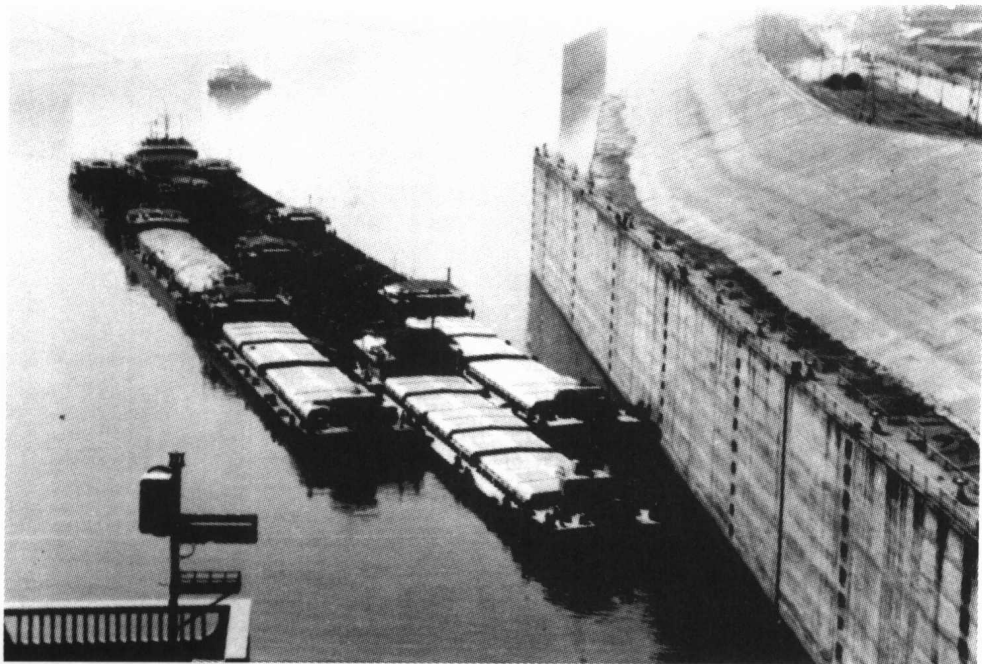
图7 一顶 9 \times 1000t 船队先带头缆调顺船队的困难情景
