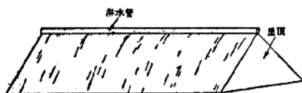
圖 12 淋水管式屋頂噴水隔熱
