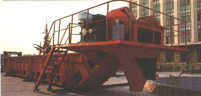
青岛锅炉辅机厂生产的 GBL-1·2×24型刮板 捞渣机(获机械部优质 产品奖)。
