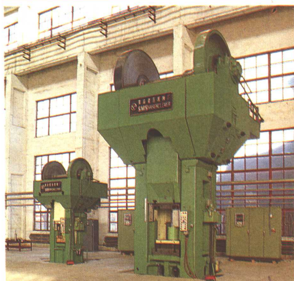
青岛锻压机械厂生产的“多角”牌 QHJ52—1600型1600千牛摩擦压 力机(获1988年第37届布鲁塞尔 “尤利卡”世界发明博览会银牌奖)。
