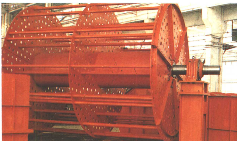
青岛锅炉金属结构件厂生产的 圆蒸发器部分组装件。
