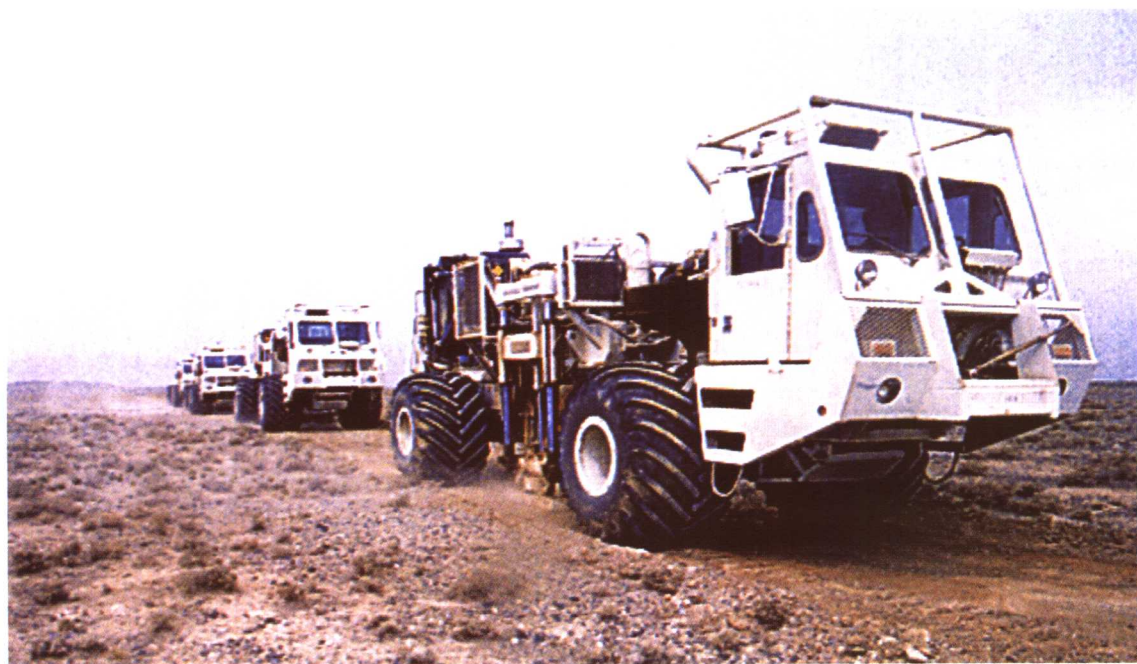
玉门油田分公司大力推广和应用先进适用的勘探新技术，坚持应用三维地震预测油气层、成像测井识别油气层、近平衡钻井保护油气层、深度酸化压裂解放油气层等四大配套技术。图为三维地震施工现场
