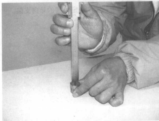
图 2-2a 用游标卡尺测深度
