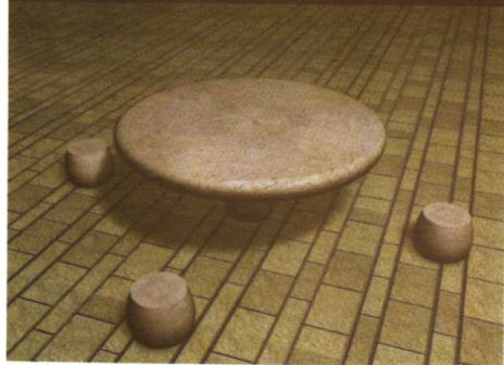
3 石凳效果 “Lathe” (旋转) 建模
