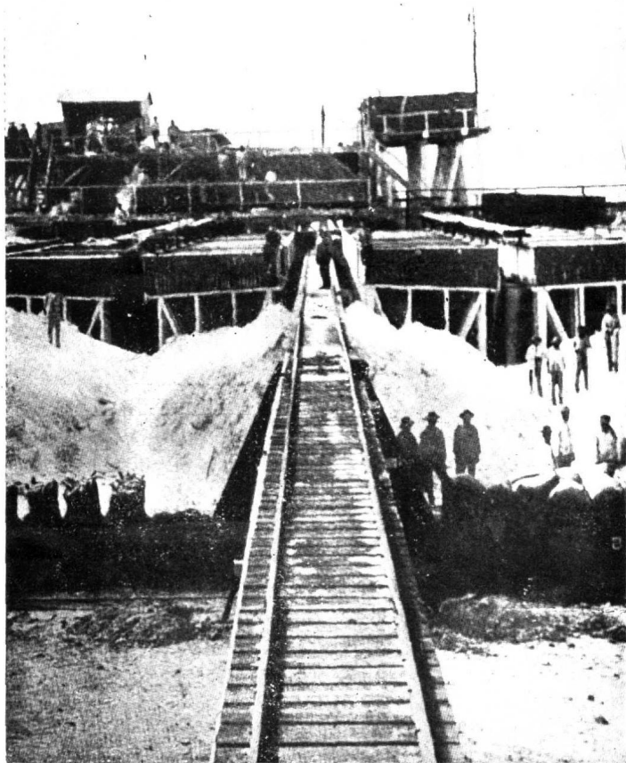
使硝酸鹽變爲純質是先將所掘石塊放在水槽中，使牠溶化沉澱，於是乃將水抽去，使之變乾，則所得白如霜雪的化學品，即爲純質的硝酸鹽。
