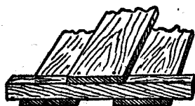
图3. 气象百叶箱底部木板的装钉
