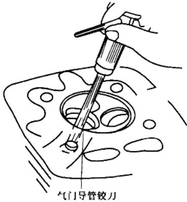
图 1-11 气门导管积炭的清除
