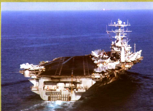
尼米兹级的着舰区斜置于飞行甲板后部，与航空母舰中心线的夹角约为12度。图为尼米兹级的6号舰CVN-73“乔治·华盛顿”号
