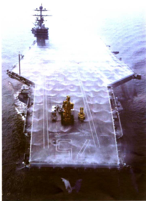
尼米兹级飞行甲板表面平坦宽阔，形状仿佛一个酒瓶，左右基本对称，整个飞行甲板包括着舰区、起飞区、停机区三大部分。图为尼米兹的8号舰 CVN-75 “哈里·杜鲁门”号
