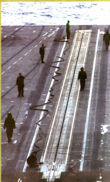
尼米兹级在飞行甲板上设置四部长94.5米的C13-1型蒸汽弹射器用于舰载机起飞
