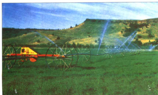
滚移式喷灌机 喷洒作业
