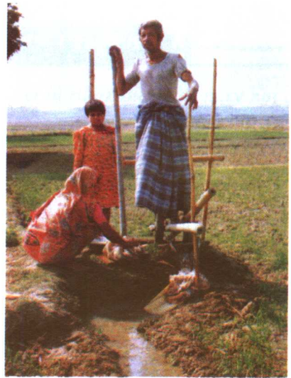
彩图 21.1 在孟加拉推广的脚踏式浅水泵
