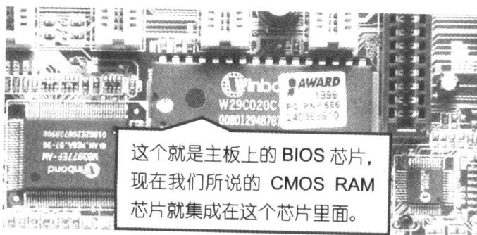
平时说的 BIOS 设置和 CMOS 设置其实都是一回事，就是通过 BIOS 程序对电脑硬件进行设置，设置好的参数放在 CMOS 芯片里面。但是 CMOS 芯片和 BIOS 芯片却是完全不同的概念。
