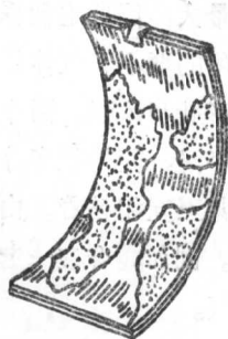
圖3 熔蝕的曲軸軸承。
