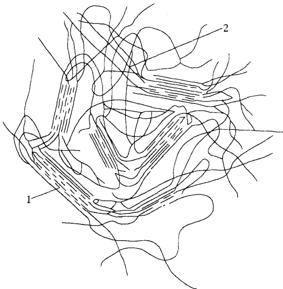
图 1.2 结晶型聚合物结构示意图
