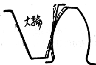
半滚动齿轮的齿形： 实线表示实际齿形； 虚线表示理论齿形。
