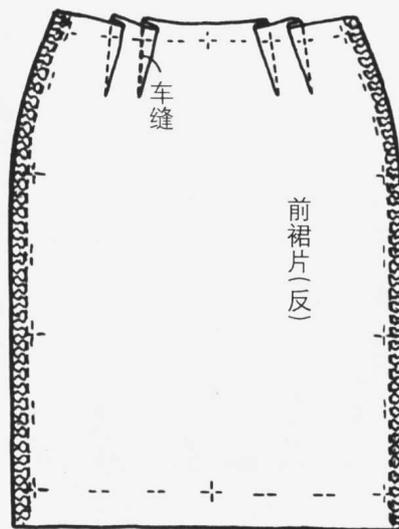
2-2 腰围的归缩，前后片都一样，离腰围净印外侧 0.2 ~ 0.3cm 处，再向外侧 0.2 ~ 0.3cm 处分别用 (2 根) 疏缝线拱针。拱针时注意不要把反省道缝头缝进去。
