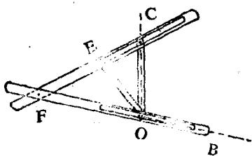
取两木条OE, OC使得长度恰好等于EF。把木条一端固定于E点，其余两点O、C可在槽内滑动（如图）。
