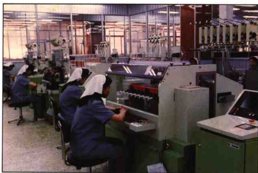
德州三合电子有限公司彩电回扫变压器生产车间
