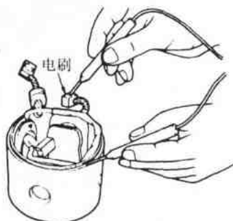
图4 磁场线圈搭铁的检查
