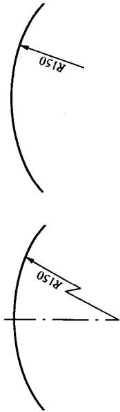
图 1-12 小圆弧半径的标注方法
