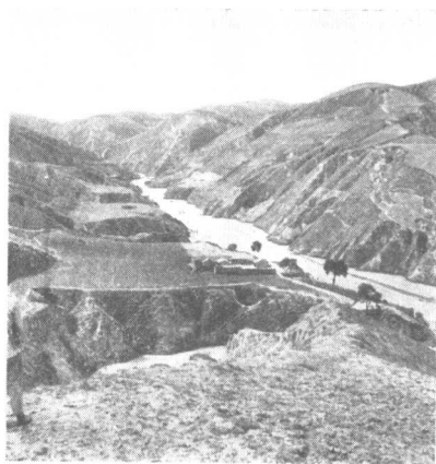
照片17 泥家溝聚之湫後所形成的泥砂沉積
