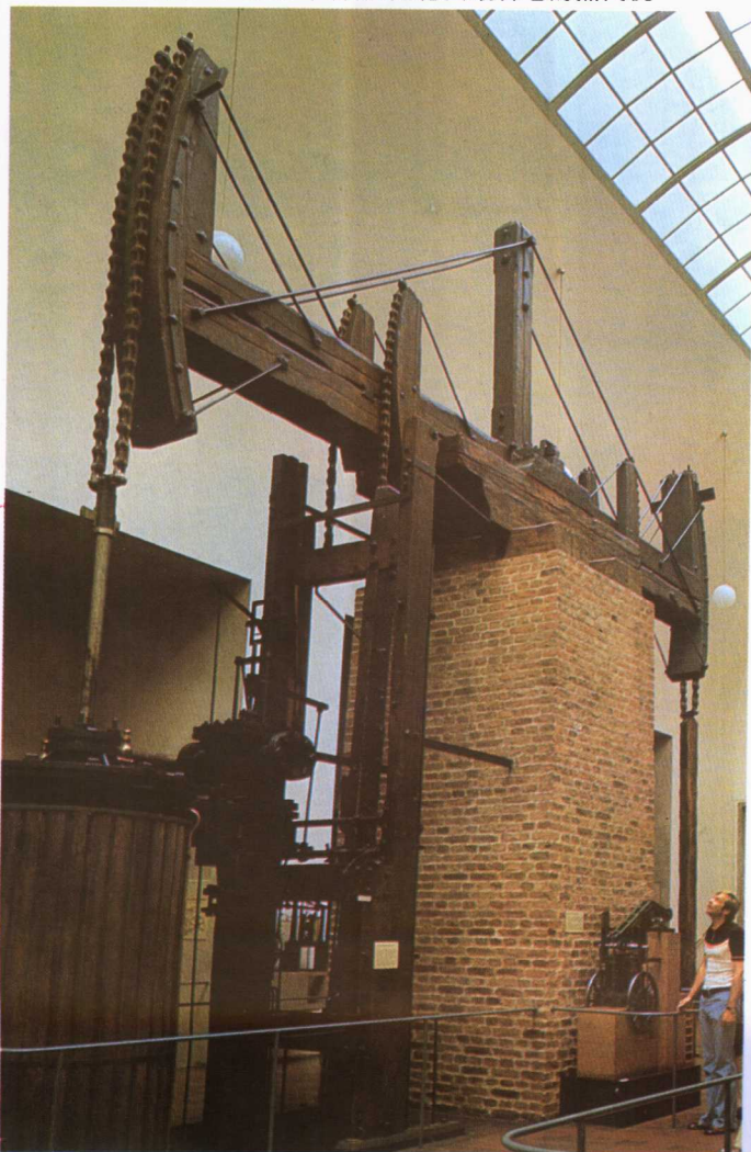
▼ 在矿山用于排水的蒸汽机 里卡尔多于 1813 年制造,是德国最古老的蒸汽机
