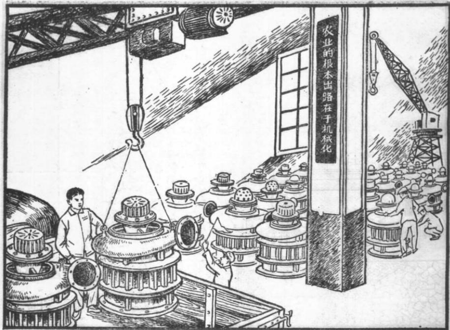
(八) 水轮泵的型号：按水轮机转轮直径尺寸分为：10、20、30、40、60、80、100等七种；按水头比分为2.5、4、6、8、10、12、18等七级。例如“高产40—6”，“高产”表示是高产牌水轮泵；“40”表示水轮机转轮直径（厘米），“6”表示在一米水头下的扬程（米）。
