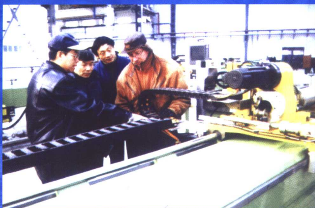
瑞典进口 76CNC 型数控弯管机
