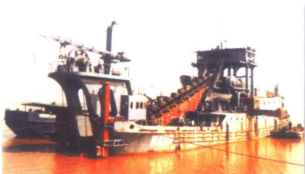
500 平方米 / 小时自航链斗式挖泥船
