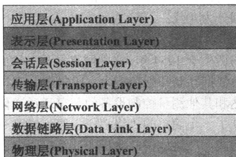
图 1.1 OSI 7 层架构示意图
