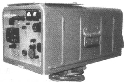
图 2-3 AGA-8 激光测距仪
