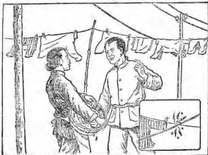
图 1-3 晒衣服等用的鉄絲碰到絕緣层损坏的导线
