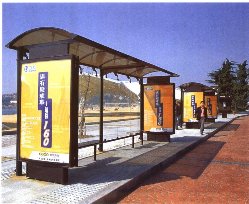
上图、下一页：半封闭式的候车廊，以大面积的玻璃作为间隔，通透明快；铸铁架上爪式螺钉结构，便于组装与更换玻璃；不锈钢条既形成对玻璃的保护，又能让乘客依靠。整个造型点与线的呼应，突显简洁的现代风格。
