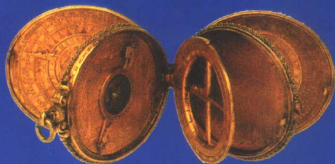
1569 年设计的航海微型仪器，集指南针、日晷、夜间借助北极星使用的时刻测定器和纬度潮汐于一身。
