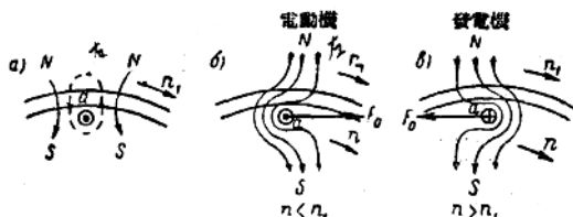
圖 38-1. 異步電機在電動機和發電機情況的運行原理
