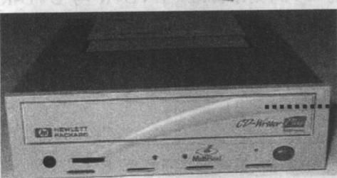
刻录机有的会标上“Writer”，或是直接标上 3 种速度：刻录 x 擦写 x 读取，如 48x24x48 表示可以 48 速刻录，24 速擦写，48 速读取。
