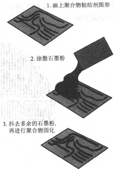
图 1.4 爱迪生的电路板制作原理
