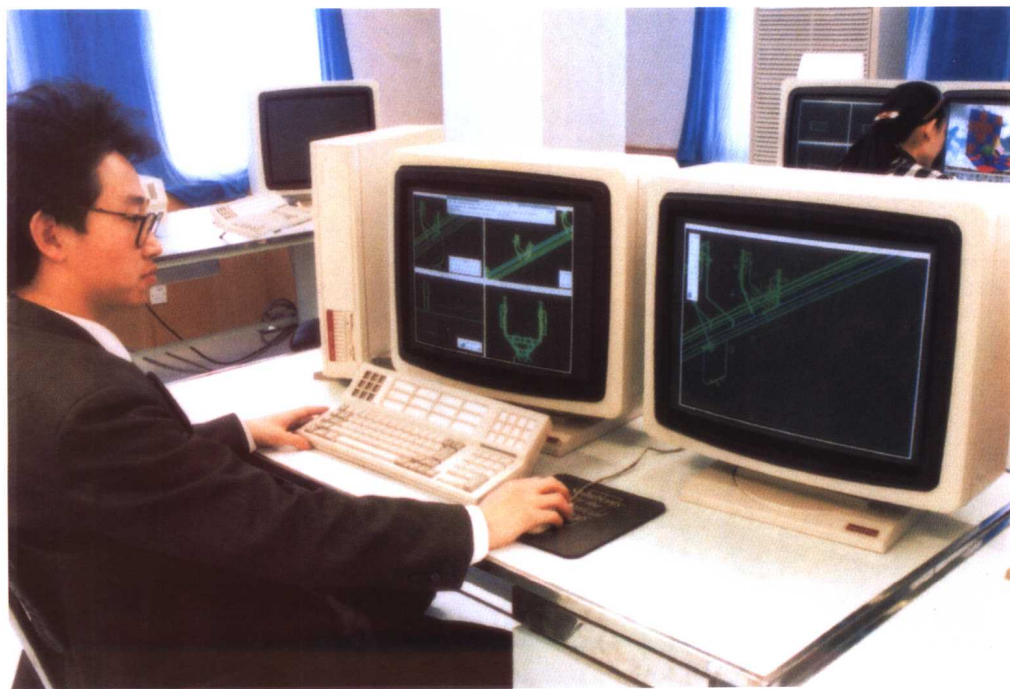
运用计算机三维设计软件设计管道线路
