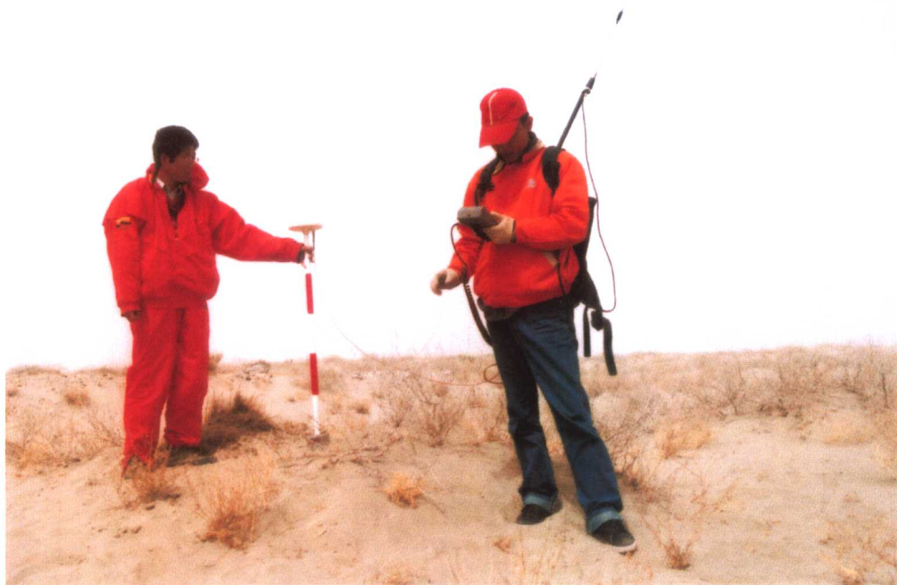
利用卫星定位和地理导航技术勘察管道线路
