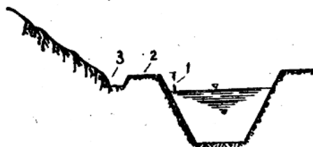
图 14 渠道的断面构造
