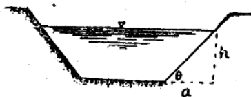
图13 渠道的横断面形状
