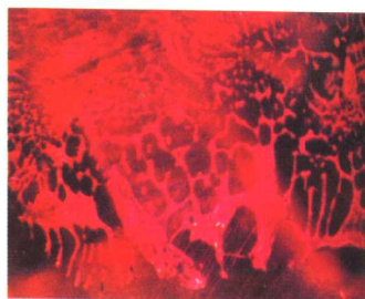
彩图 16 助熔剂法合成红宝石中的网状助熔剂残余
