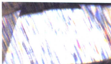
彩图 10 高温高压处理钻石在正交镜下的干涉纹
