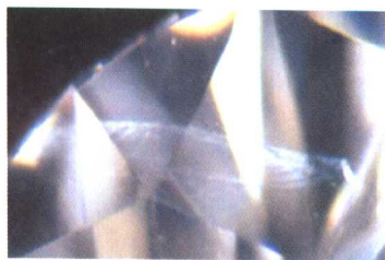
彩图 9 充填钻石，充填裂隙处无“闪光效应”
