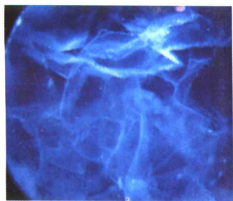
彩图 17 焰熔法合成蓝宝石中的烟云状熔融
