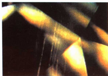
彩图 6 合成碳化硅中的针状包体
