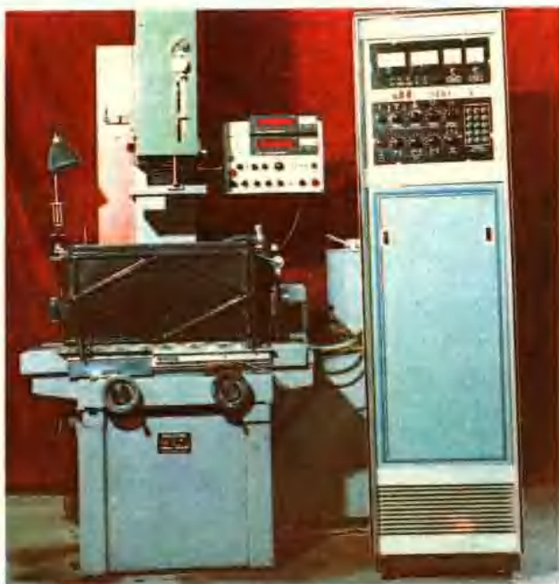
泰山劳改支队张宪宽研制的全静无 导轨精密电火花机床，荣获全国科技大会奖。
