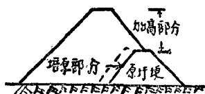
圖三 圩內坡一面加堤
