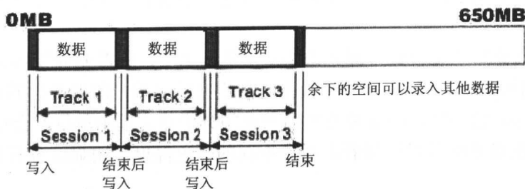
图 1-2 Track-at-Once 刻录模式图解
