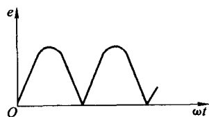
图 1—11 一个线圈时电刷两端电动势的波形
