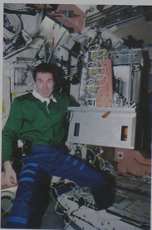
国际太空站上的航天员在二氧化碳清除装置旁工作。
