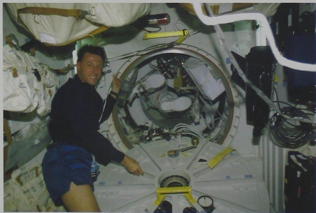
航天员准备关闭航天飞机气闸舱的舱门，以便气闸舱内的航天员进行出舱活动。
