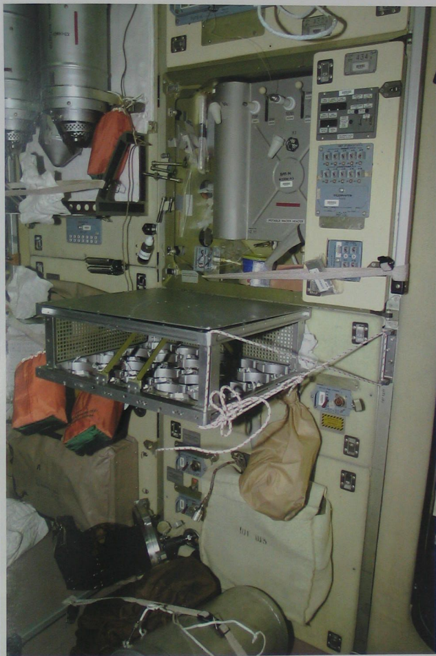
国际太空站服务舱中的厨房，正中是饮用水加热器，水分配器在加热器的上部，有热水和温水出水口。
