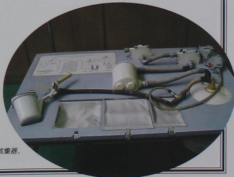
国际太空站服务舱中的厨房，正中是饮用水加热器，水分配器在加热器的上部，有热水和温水出水口。
