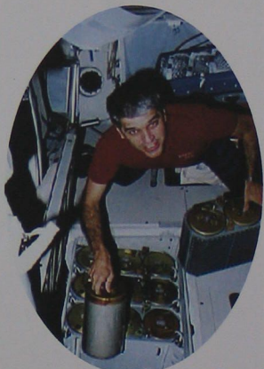
国际太空站上的航天员在更换氢氧化锂贮罐。
