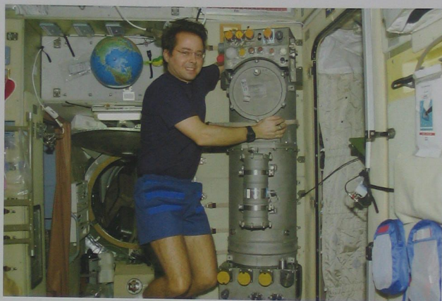
国际太空站服务舱的电解水产生氧气设备。
